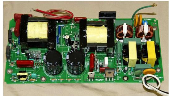
**INDUCTION LAMP BALLAST CIRCUIT BOARD**
